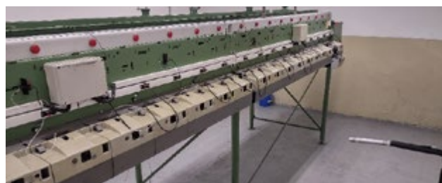
Obr. 1: Vretenník spriadacieho stroja uložený v ložisku a skúšobné zariadenie vretenníkov
