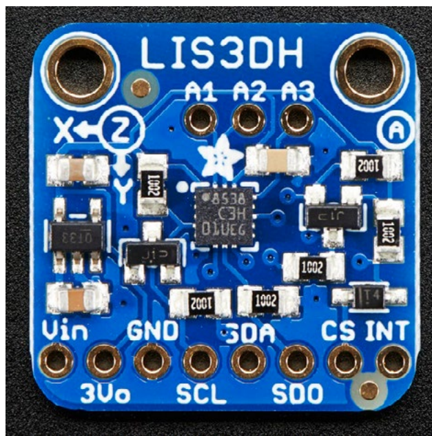
Obr. 5 Pohled na destičku akcelerometru Adafruit LIS3DH
