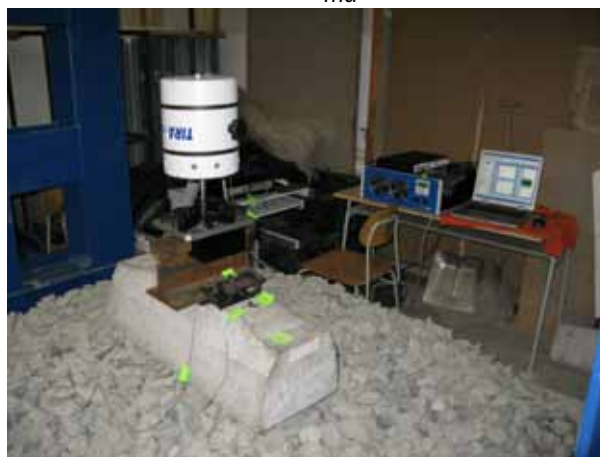
Obr. 1a: Zkušební vzorek železničního svršku v laboratoři - schéma
